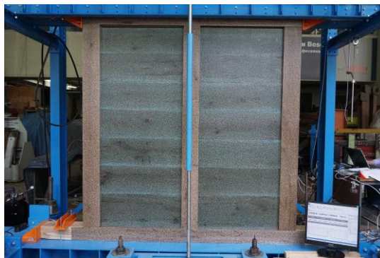
Фиг. 3. Схема на опитната установка при мониторинга на талпено-стълбова стена
